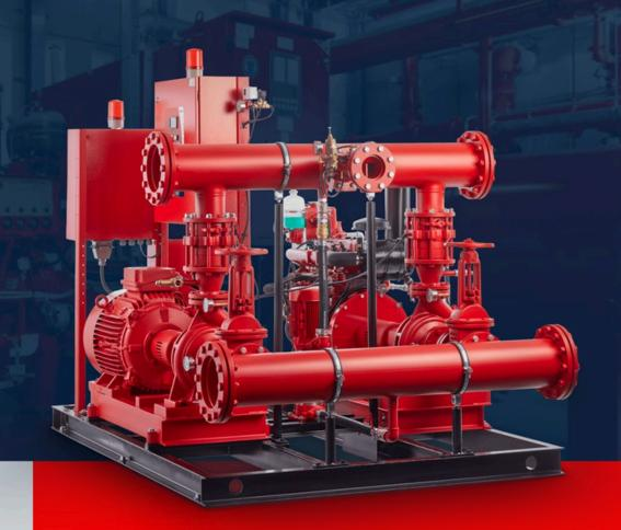
تعمـل مضخـات الحريـق إمـا بواسـطة محـرك كهربائـي أو محـرك ديــزل , أو فـي بعـض الأحيـان توربيـن بخـاري. إذا كان رمـز البنـاء المحلـي يتطلـب طاقـة مسـتقلة عــن شــبكة الطاقــة الكهربائيــة المحليــة , فقــد تســتخدم المضخـة التــي تســتخدم محـركاً كهربائيــاً , عنــد توصيلهـا عبـر مفتــاح تحويــل مــدرج , تركيــب مولــد الطــوارئ.
